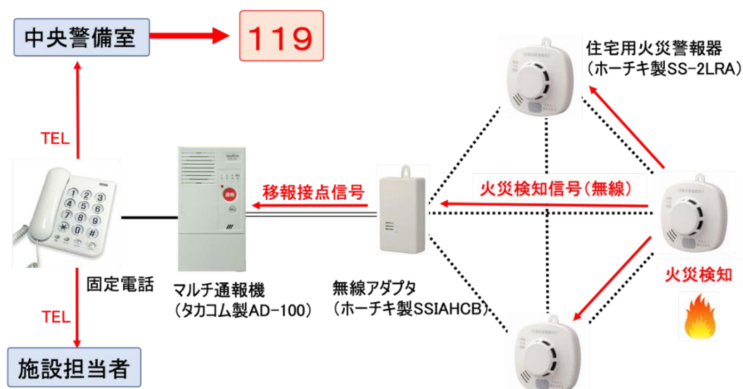
図 2.8.2-2 住宅用火災警報器と汎用通報装置を用いた代替火災監視 火災警報器が火災を感知すると中央警備室へ自動的に通報され、迅速な 119 番通報及び初期対応が可能となる。
